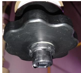
Imagen del conector sometido a columna de agua de 3 metros para verificación de estanqueidad.
