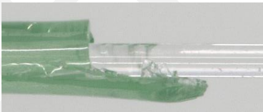
Remoção imperfeita do acrilato, vista por microscópio.
