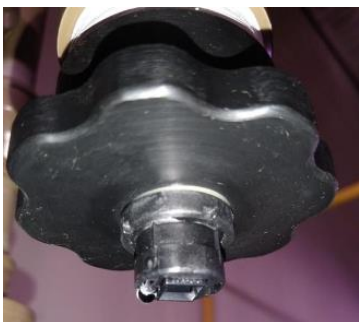
Imagem do conector sujeito a coluna de 3m de água para verificação de imersão.
