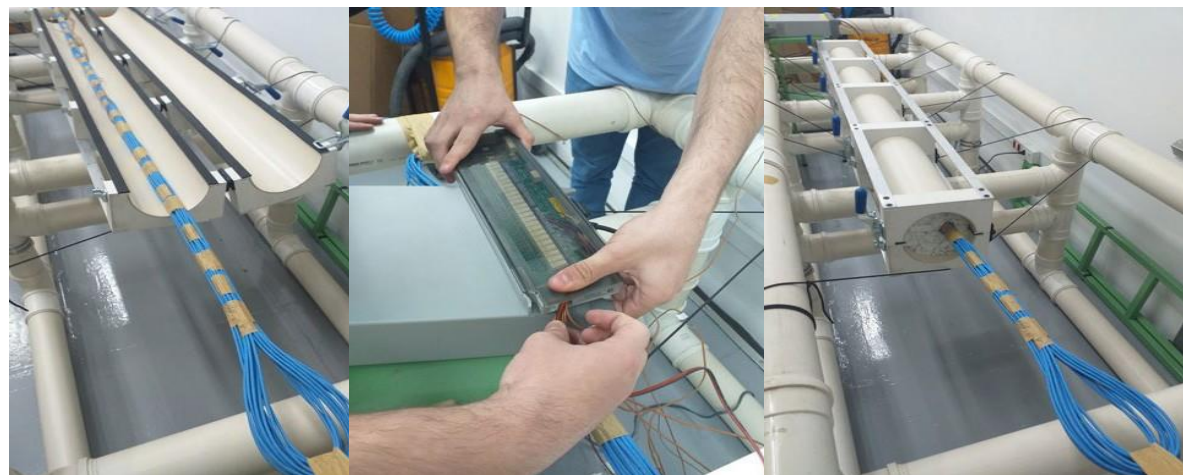
Figura 2. Captador de datos y termopares. Fuente: pruebas Internas (Furukawa)
